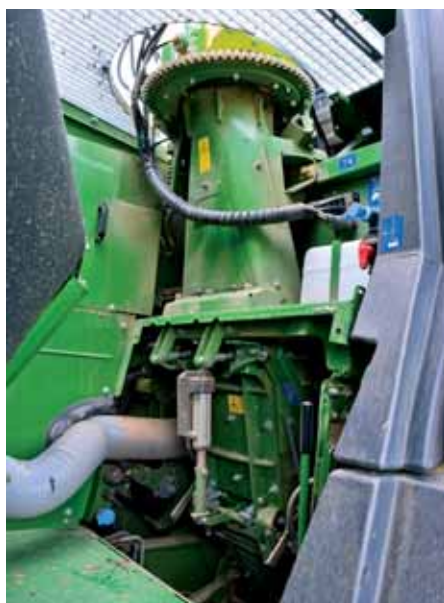
Výmena trávnej šachty za kondicionér je vďaka VariQuick výrazne rýchla a pohodlná. Rotujúce sito (vľavo) s odsávaním nečistôt priamo do komína znižuje možnosť upchatia chladičov.
