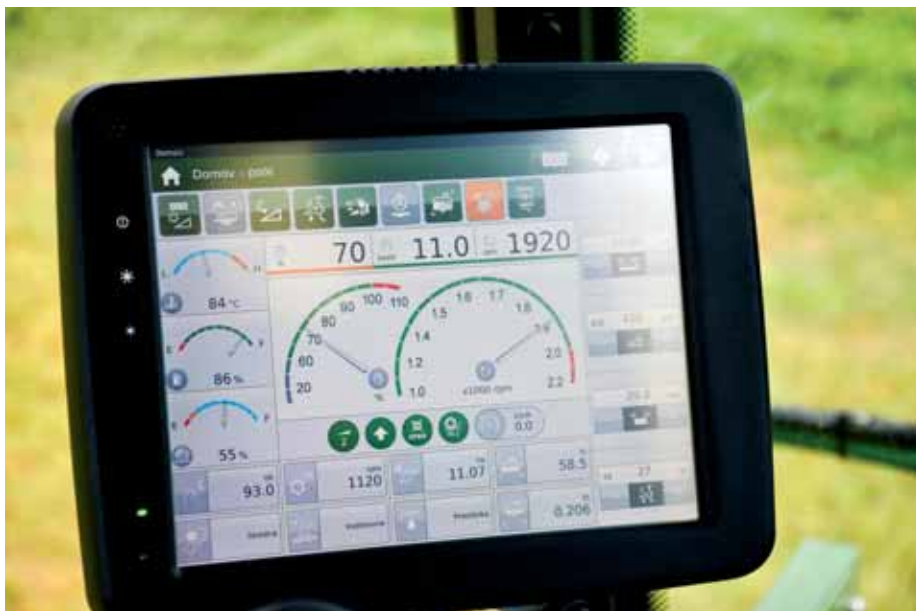
10 palcový displej s hlavným menu počas práce. Krone dodáva do rezačky niekoľko automatizačných prvkov, ktoré výrazne zjednodušujú a zefektívňujú prácu.
