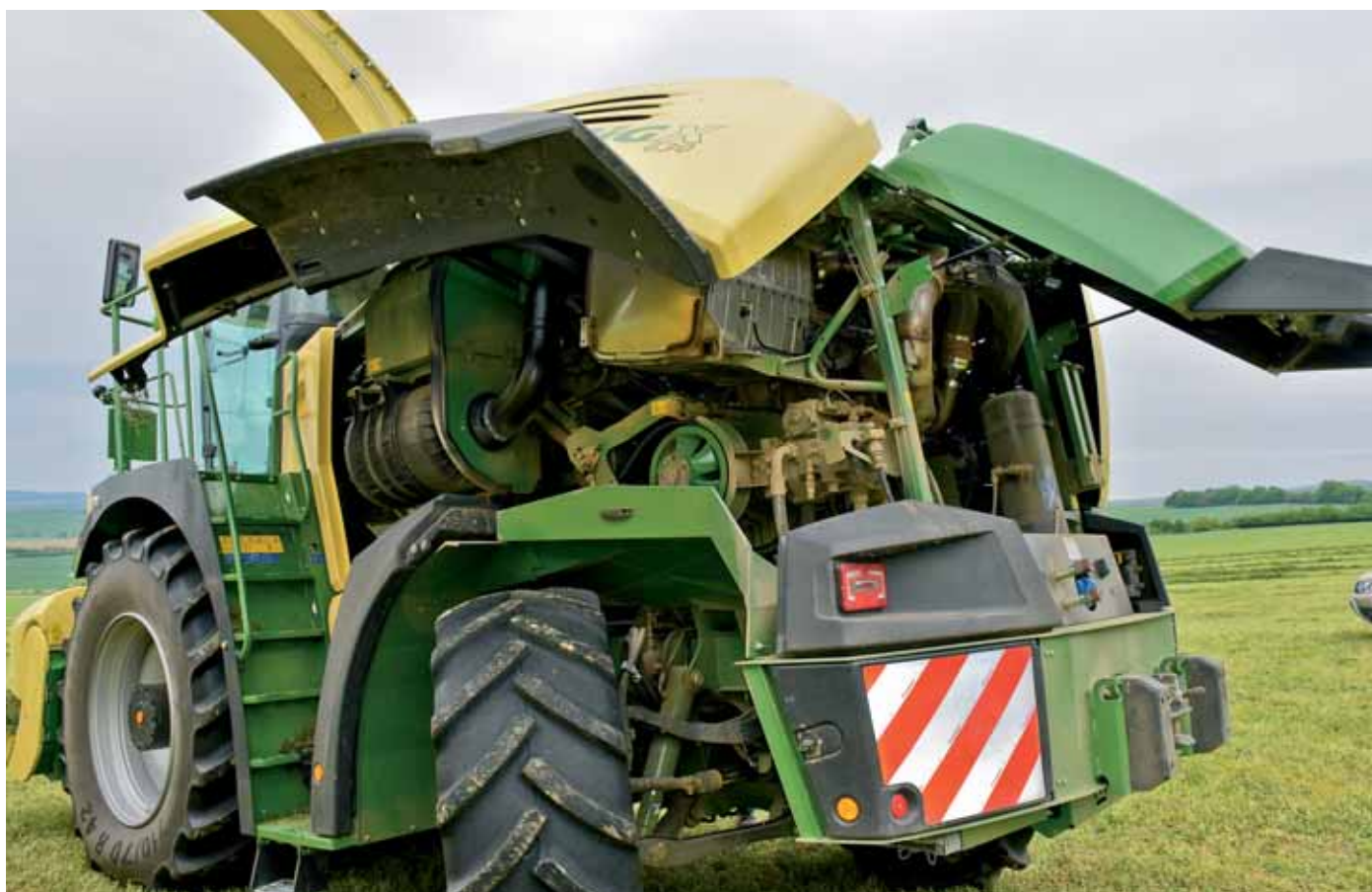
Pohonnou jednotkou je dobre prístupný šesťvalec MTU s objemom 15,6 l, v tomto prípade nastavený na výkon 626 k.
