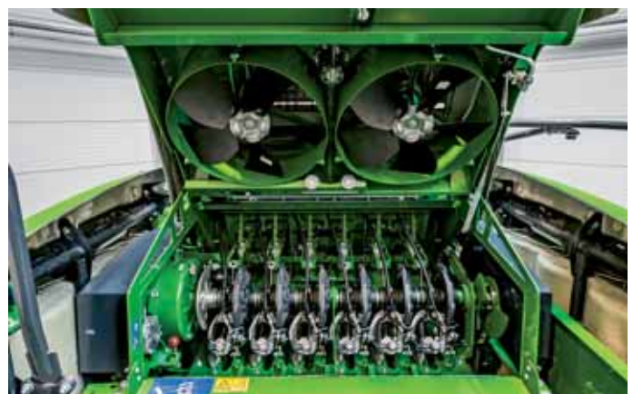
Nový systém čistenia PowerClean ofukuje nielen uzľovače, ale aj značnú časť stroja.
