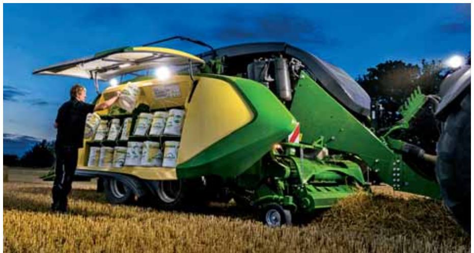
Zásobníky špagátov integrovali do bočných krytov. Kryty sa vysúvajú v dvoch režimoch pomocou hydrauliky a zabezpečujú výborný prístup pre servis a údržbu.
