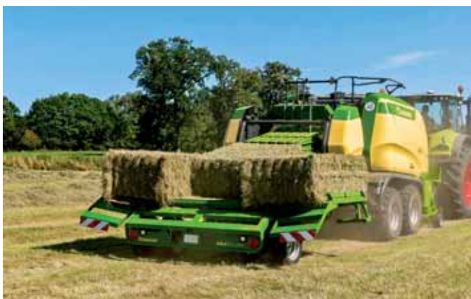
Novinka obsahuje všetky potrebné komponenty pre pripojenie akumulačného voza BaleCollect.
