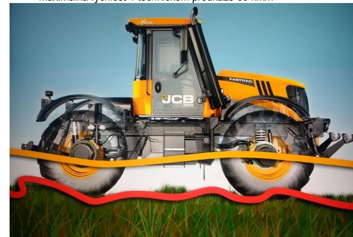
Obr. Konceptcia odpruženia, podvozku a kabíny Fastracu. Žltá čiara – plynulá jazda FASTRACu cez nerovnosti, červená čiara – jazda cez nerovnosti a reakcia štandardného traktora.
