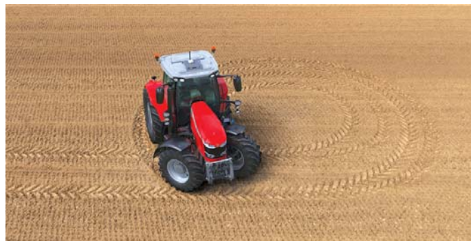
Polomer otáčania činí 4,75 m, pneumatiky Michelin VF možno pri práci nahustiť iba na 0,6 baru.
