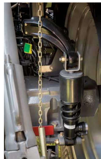
Aktívne mechanické pruženie tlmí vertikálne pohyby aj náklony. Viete ho nastaviť, alebo používať automatický mód.
