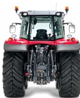
Zadný trojbodový záves udvihne 9 600 kg náradie. K dispozícii vie byť spolu s prednou časťou 8 hydraulických okruhov.
