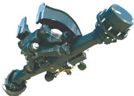
Predná náprava QuadLink s paralelogramovým vým zavesom má dráhu pruženia 90 mm.
