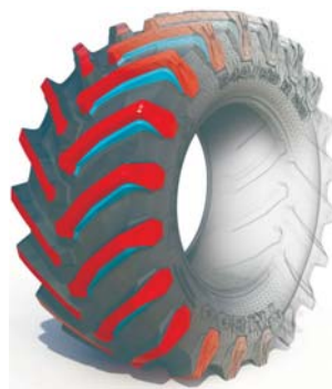
Polomer otáčania činí 4,75 m, pneumatiky Michelin VF možno pri práci nahustiť iba na 0,6 baru.
